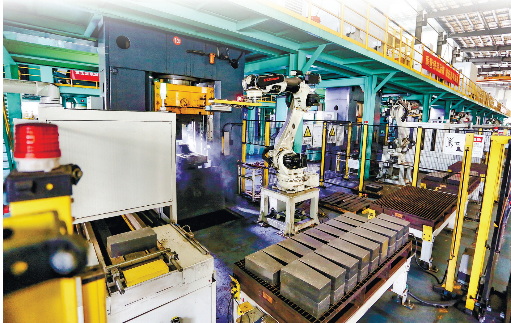
在瑞泰马钢RH精炼炉用节能环保型新材料数字化车间里,机械臂精准地抓取、码放一块块深灰色的砖坯。通讯员 毕琛 摄
